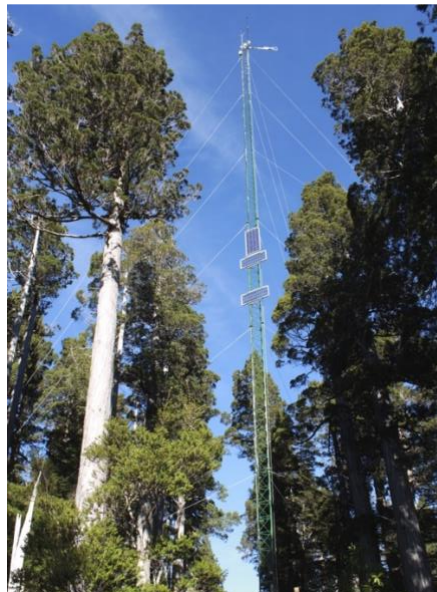
La torre de 36 metros de altura y sus instrumentos sobre el dosel del bosque.
