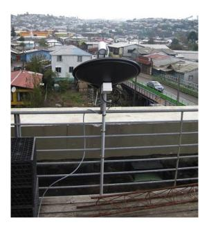
El micro-radar de precipitación entrega información sobre la distribución del tamaño de las gotas de lluvia en una columna vertical sobre el instrumento.
