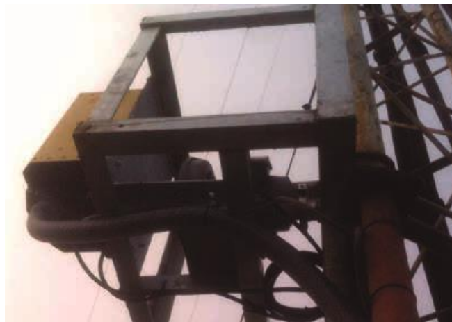
El monitor de niebla fue instalado a 20 metros de altura en una torre de transmisión celular de la compañía Telefónica.
