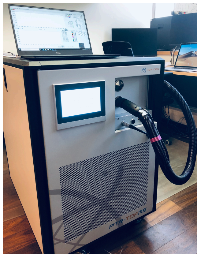
Analizador PTR-TOF-MS midiendo compuestos orgánicos volátiles en el Campus Beauchef de la Universidad de Chile.
